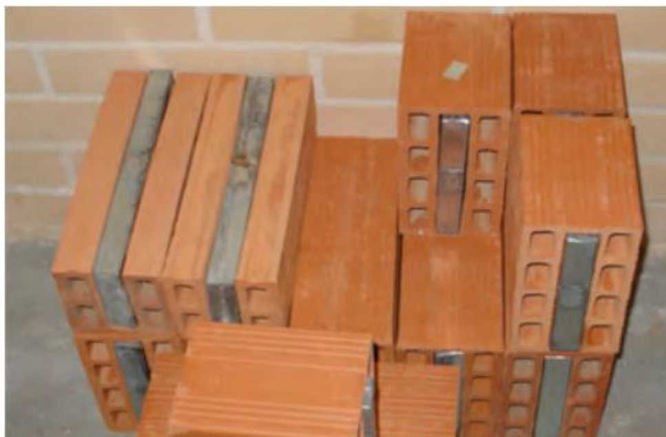
Rysunek 20. Pustaki ceramiczne z wkładem z materiałów zmiennofazowych 90
