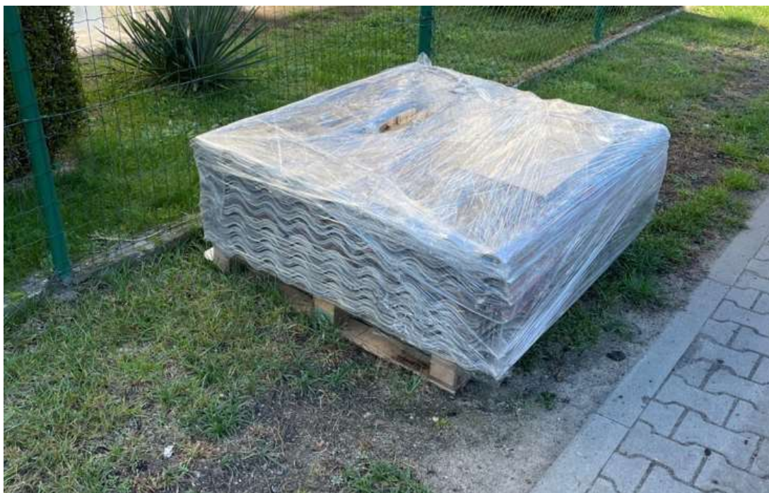
Rysunek 7 Zabezpieczona paleta płyt falistych azbestowo – cementowych zakwalifikowana jako I stopień pilności.
